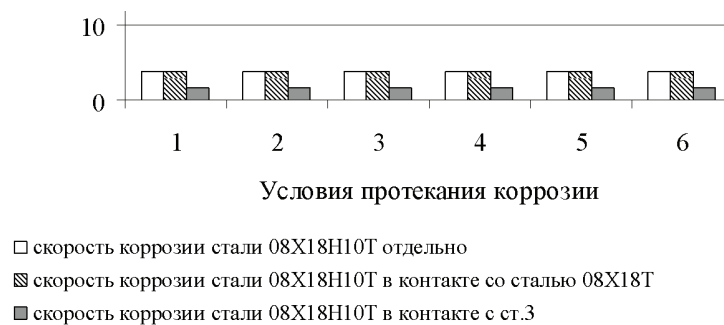
Рис. 3 Скорость коррозии стали 08X18N10Т в пластовой воде отдельно и в контакте со сталями 08X18Т и Ст.3: 1 – в закрытой емкости без перемешивания; 2 – в закрытой емкости с перемешиванием; 3 – в закрытой емкости с перемешиванием электролита, содержащего песок; 4 – в открытой емкости без перемешивания; 5 – в открытой емкости с перемешиванием; 6 – в открытой емкости с перемешиванием электролита, содержащего песок
