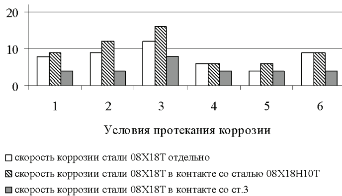
Рис. 2 Скорость коррозии стали 08X18Т в пластовой воде отдельно и в контакте со сталями 08X18N10Т и Ст.3: 1 – в закрытой емкости без перемешивания; 2 – в закрытой емкости с перемешиванием; 3 – в закрытой емкости с перемешиванием электролита, содержащего песок; 4 – в открытой емкости без перемешивания; 5 – в открытой емкости с перемешиванием; 6 – в открытой емкости с перемешиванием электролита, содержащего песок
